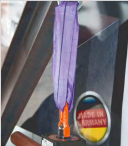
Ein Lasthebemagnet ist so zuverlässig wie die einzelnen Komponenten in einer Halte-Vorrichtung. Deshalb empfehlen wir für sichere Anwendungen mit unseren Magnetprodukten die Alfa -Rundschlingen aus 100 Prozent reißfestem Polyester. Von diesen extrem belastbaren Helfern sind wir so überzeugt, dass wir sie täglich in unseren eigenen Werkhallen einsetzen.
