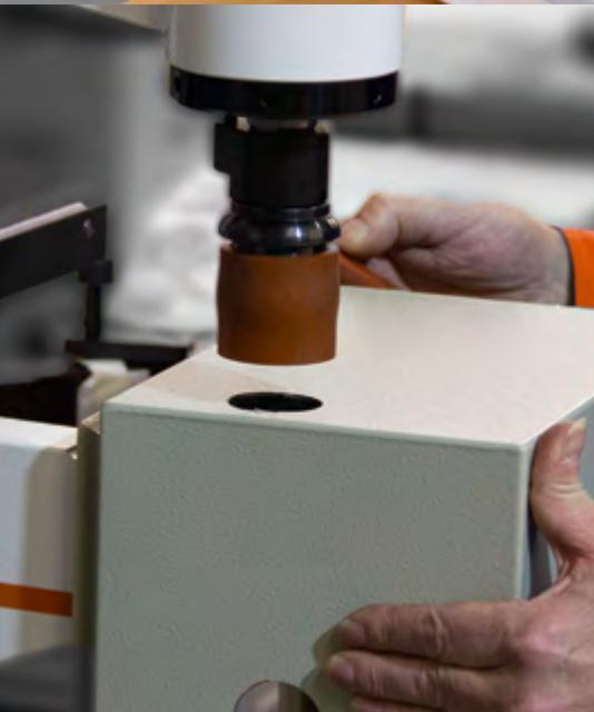
„Wer Produkte nah an den Bedürfnissen von Schaltschrankbauern produzieren möchte, muss tief in deren Arbeitswelten eintauchen. Die Geräte aus der Press-Serie verfügen deshalb über verschiedene, auf die Anforderungen des Handwerks abgestimmte Details. Ein Beispiel: Dank unterschiedlicher Matrizenauflagen stanzen die Anwender auch im extremen Randbereich. Ein Laserpointer zeigt die Werkzeugmitte an.“
