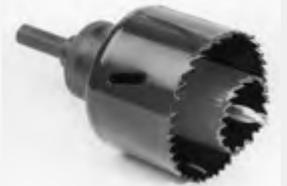
Nehmen Sie eine Lochsäge mit 32 mm Ø und schrauben Sie diese innerhalb der Lochsäge auf das hervorstehende Gewinde der Aufnahme A2. Die innere Lochsäge dient so als Führungslochsäge, um existierende Löcher zu erweitern, siehe Bild.
