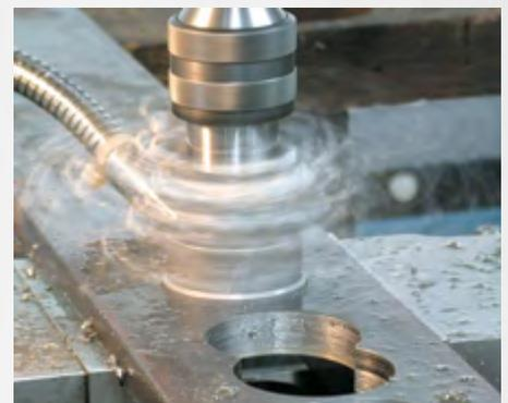
Bohren in Flachstahl
