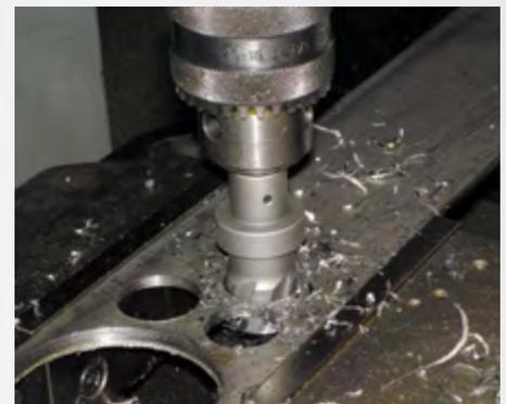
Bohren in Flachstahl
