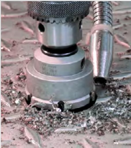
Zeigen Sie neuen, herausfordernden Projekten die Zähne – mit Alfra Lochsägen und Mehrstufenbohrern. Edelstahl, unlegierte Stähle, Aluminium, Kunststoff oder Leichtbauplatten sind kein Problem für unsere robusten Dauerläufer.
