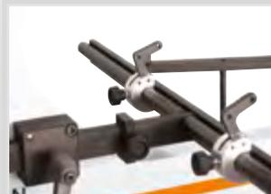
Längens- und Tiefenanschlag mit klappbaren Nachsetzanschlägen
