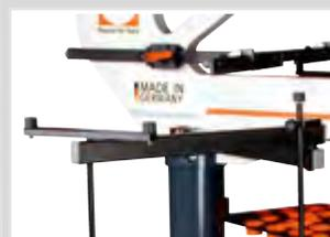
Schwenkbare Abstützarme, höhenverstellbar mit je 2 Gummiauflagen
