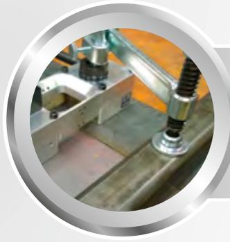
**Magnete lassen sich individualisieren. Hierfür sorgen zusätzliche Gewindeverschraubungen im Gehäuse**
