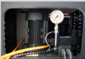
Zweikreis hydraulikaggregat im Schrankunterbau
