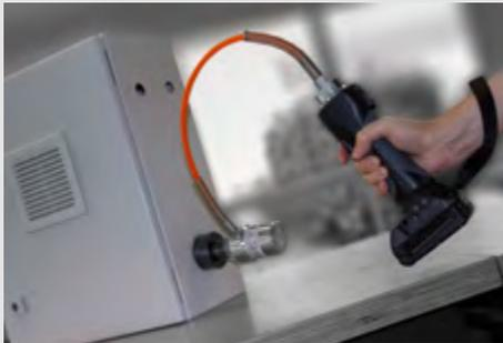
Scharfe Schneidgeometrie trifft auf hydraulische Kraft – eine mehr als glückliche Verbindung. Alfra Blechlocher überzeugen als gratfreie und geräuscharme Alternative zur Säge. In Anwendung mit unseren Handstanzen erledigen Sie Gehäusedurchbrüche so schnell und zeitsparend wie nie.
