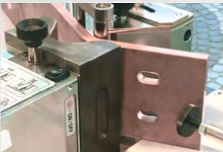
Ohne Stromschienen läuft im Schaltschrank buchstäblich nichts. Deshalb sorgen unsere Schneid-, Biege- und Lochgeräte dafür, dass Kupferschienen schnell und verlässlich genau die Form erhalten, die der Bauplan vorgibt. Durch einfaches Einsetzen von Lochstempeln sind verschiedene Anwendungen mit nur einem Arbeitszylinder möglich.
