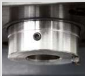
Stabile Kolbenstange (Ø 55 mm) mit Werkzeugverdrehungssicherung
