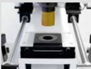
Matrizenbettauflage. Werkzeugwechsel auch bei eingespannter Schaltschranktür.
